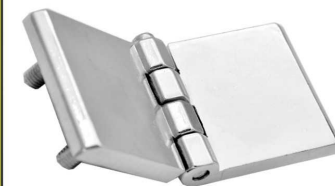
* لولا سربی پیچ نصب ۱۲۰*۶۰ سطح نهایی : آبکاری نیکل کروم سایز پین : ۷ میلیمتر سایز پیچ : M8
