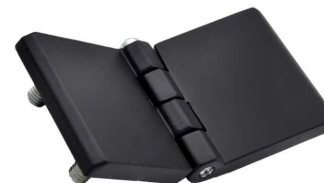
* لولا سربی پیچ نصب ۱۲۰*۶۰ سطح نهایی : رنگ استاتیک مشکی سایز پین : ۷ میلیمتر سایز پیچ : M8
