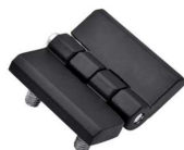
* لولا سربی پیچ نصب ۴۰*۴۰ سطح نهایی : آبکاری نیکل کروم سایز پین : ۵ میلیمتر سایز پیچ : M5
