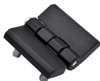
* لولا سربی پیچ نصب ۵۰*۵۰ سطح نهایی : آبکاری نیکل کروم سایز پین : ۶ میلیمتر سایز پیچ : M6
