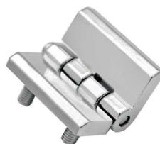
* لولا سربی پیچ نصب ۶۰*۶۰ سطح نهایی : آبکاری نیکل کروم سایز پین : ۷ میلیمتر سایز پیچ : M8
