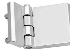
* لولا سربی پیچ نصب ۹۰*۶۰ سطح نهایی : آبکاری نیکل کروم سایز پین : ۷ میلیمتر سایز پیچ : M8
