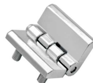
* لولا سربی پیچ نصب ۵۰*۵۰ سطح نهایی : آبکاری نیکل کروم سایز پین : ۶ میلیمتر سایز پیچ : M6
